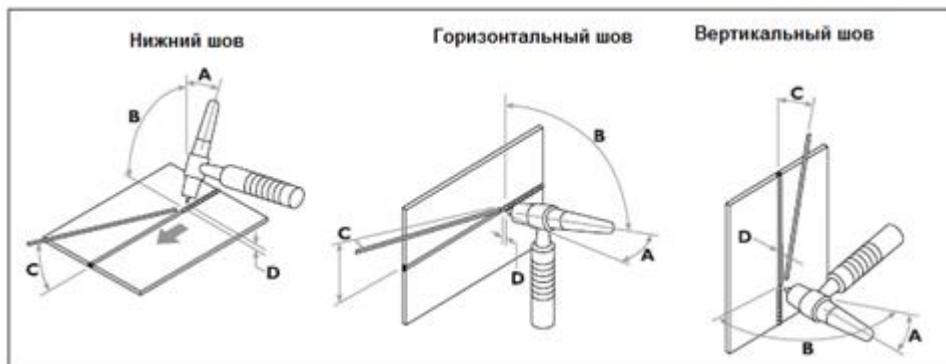
**Рисунок 24. Базовые движения при работе с аргодуговой горелкой**
