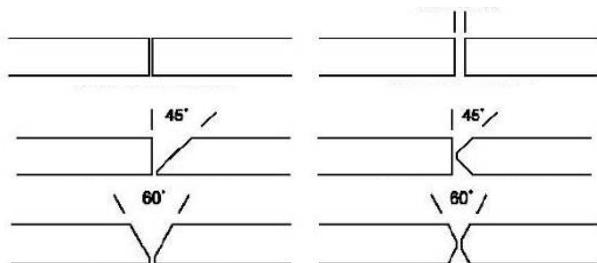
**Рисунок 10. Стыковые соединения**
