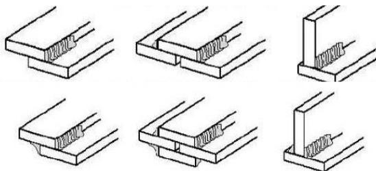
**Рисунок 11. Угловые соединения**
