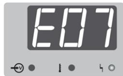
Если индикатор горит, а на табло отображается ошибка E 07, это означает, что аппарат находится в режиме защиты от случайного контакта горелки с рабочей поверхностью. После того как сварщик нажмет кнопку на горелке, защита будет отключена, ошибка исчезнет, индикатор погаснет и можно будет продолжить работу.
