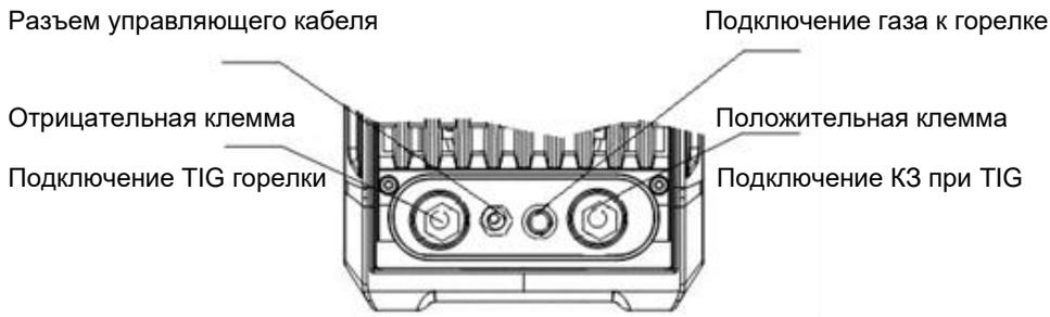
Рисунок 7. Разъемы подключения
