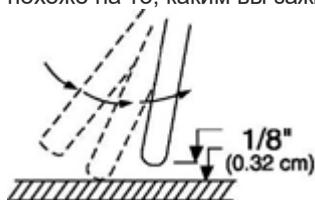
Рисунок 13. Зажигание дуги
